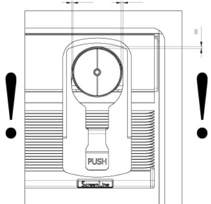
2. Přesně dle obr. nalepte podložku ovladače.
